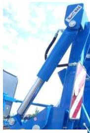
Hidraulinė apsauga — veikianti jėga 1700 kg.
